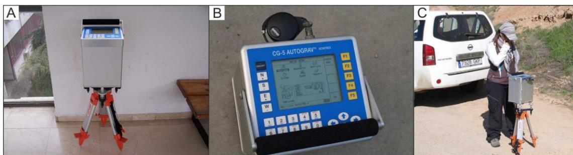
Figura 15: Equipo de gravimetría. (A) Gravímetro Scintrex Autograv CG-05 sobre trípode; (B) Detalle de la pantalla de adquisición; (C) Realización de una medida gravimétrica sobre trípode.
