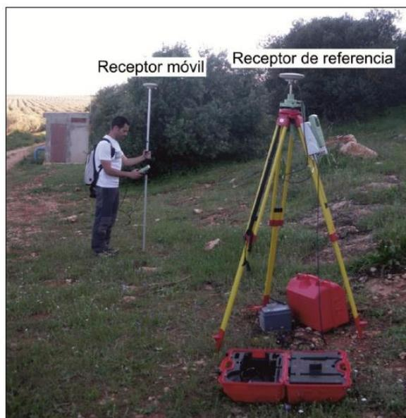
*Figura 16: Equipo GPS Leica 1200 para posicionamiento de las estaciones de medida.*
