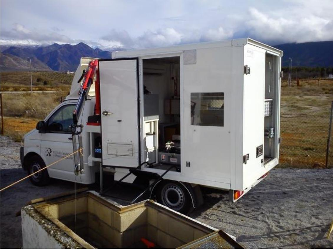
*Figura 20: Unidad móvil del IGME para la adquisición de diagráfias en sondeos y ensayos slug.*
